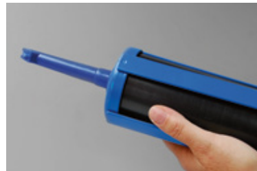
5./6. Die Rigiton® Fix Pistole etwas hochhalten und solange den Abzug betätigen, bis keine Luft mehr in der Kartusche vorhanden ist und das Rigips® Vario Fugenspachtelmaterial aus der Fugendüse ohne Unterbrechung austritt.
