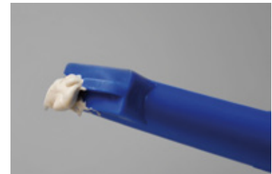
5./6. Die Rigiton® Fix Pistole etwas hochhalten und solange den Abzug betätigen, bis keine Luft mehr in der Kartusche vorhanden ist und das Rigips® Vario Fugenspachtelmaterial aus der Fugendüse ohne Unterbrechung austritt.
