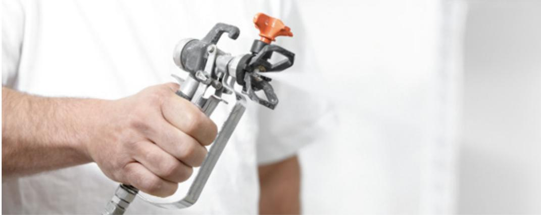
Der Rigips® ProMix Systemspachtel kann auch mit einem geeigneten Sprühgerät maschinell verarbeitet werden.
