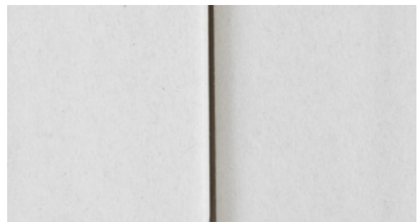
Scharfe Kante (linke Platte) an voll kartonummantelte Kante (rechte Platte).
