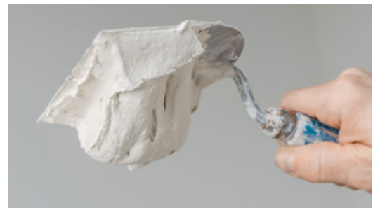
Die Konsistenz des angerührten Fugenspachtels sollte so sein, dass das Material von der umgekehrten Kelle nicht abrutscht (Kellentest).
